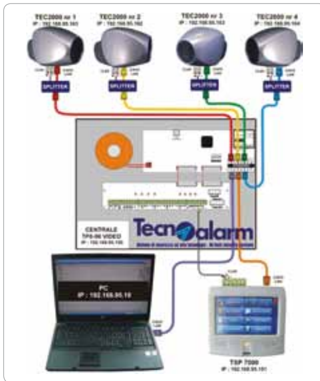
Obr. 1 Hybridný zabezpečovací a kamerový systém (8xIP kamera) na báze prvkov Tecnoalarm. Možnosť pripojiť drôtové (NO/NC, dvojito vyvážené, zbernicové) aj bezdrôtové detektory
