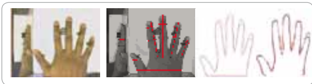
Obr. 4 Ruka se zrcadly snímaná CCD kamerou a příklad měření vzdáleností
